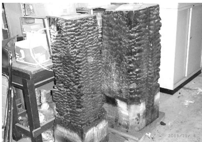
写真4 耐火性能実験に使用されたサンプル
